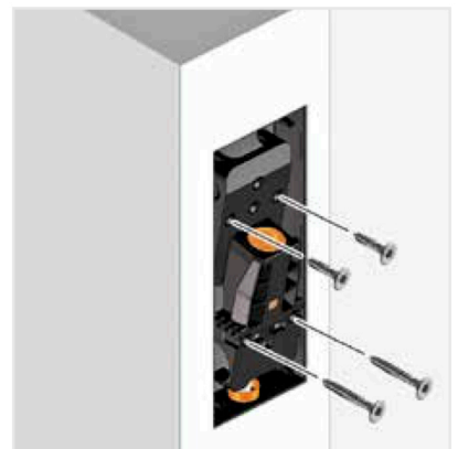
Mit je 2x \varnothing 4 \times 20 mm und 2x \varnothing 2 \times 40 mm Fixierschrauben auf Toleranzgitter sichern
